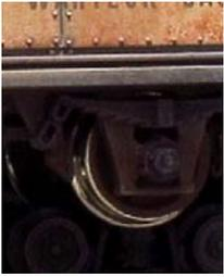
Vous pouvez complètement changer le look de vos voitures en montant nos essieux Fine Scale nickelés. Avec une peinture sur l'essieu et sur le flanc des roues vous mettez en lumière une bande de roulement semblable à la réalité. Diamètre des roues : 8,75 mm. Nos essieux sont vendus en sachet de 4, le boudin de nos roues est réalisé en code RP 25 selon norme Nem 88. Adaptés à toutes les voitures voyageurs de BEMO et à la plupart des wagons. Commande en quantité possible, nous consulter.
